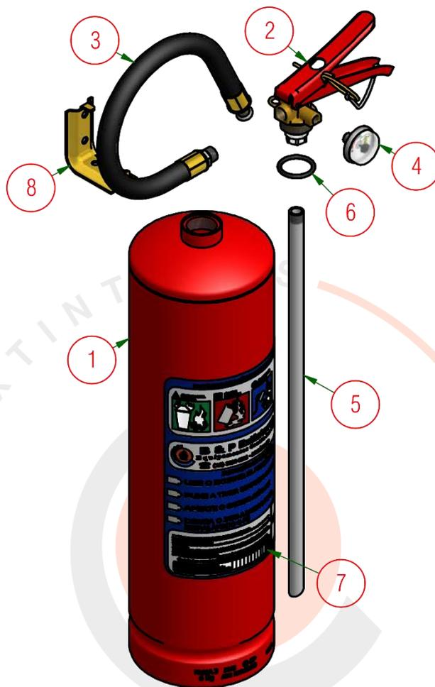
Figura 1 - Componentes do Extintor de Incêndio 6 kg ABC
