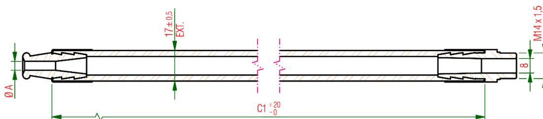
Figura 4 - Dimensões da Mangueira de Descarga
