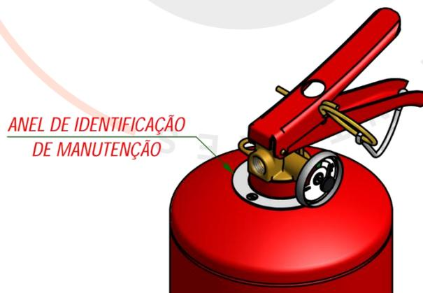
Figura 9 - Anel de Identificação de Manutenção
